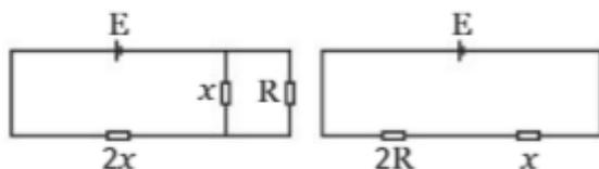
1. Déterminer la résistance équivalente  $R_{eq_1}$  pour le premier montage en fonction de  $x$  et  $R$ .
